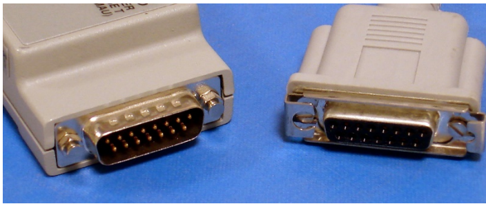
Attachment Unit Interface (AUI)
